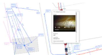
Billede 3: Afbudsledninger og tilhørende kloak-TV til vurdering af tilstanden på ledningsnettet.
